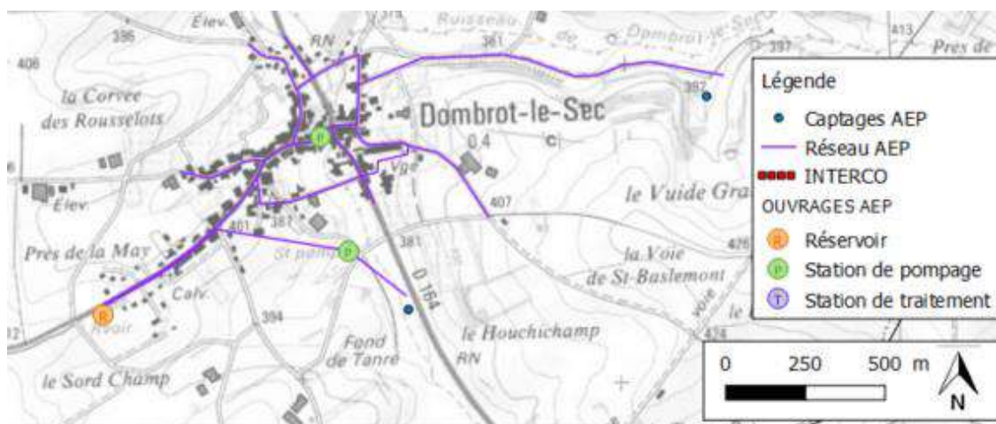
Fig. 25. Infrastructure AEP de la commune de Dombrot-le-Sec
