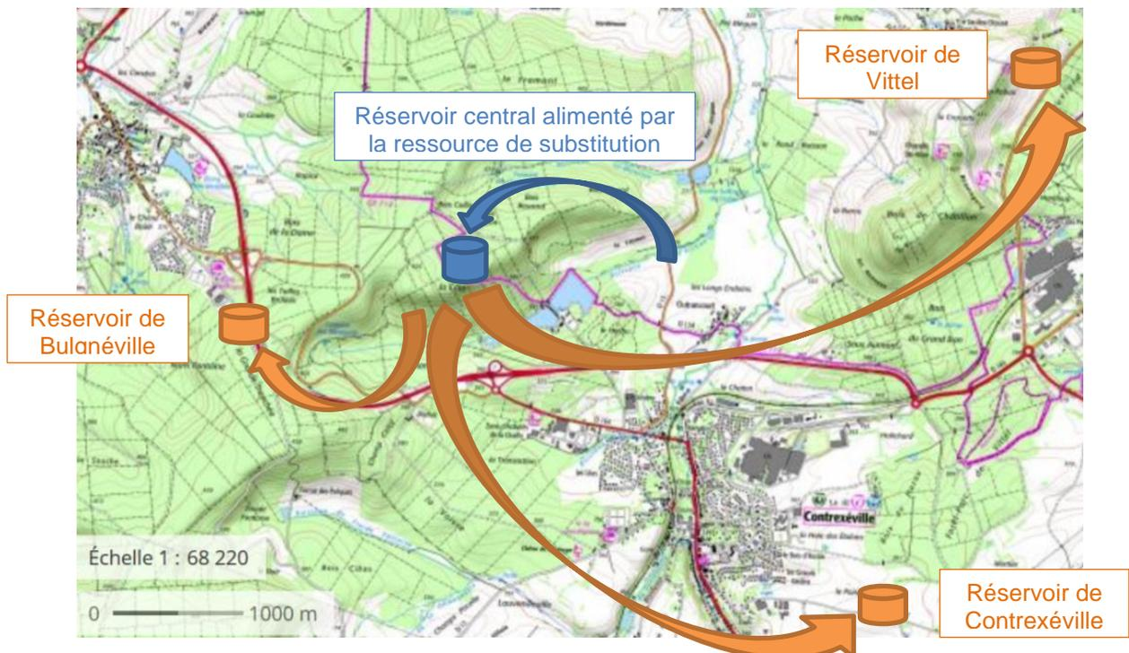
**Fig. 13. Proposition d'implantation du réservoir central et schéma de distribution vers les réservoirs existants de Bulgnéville, Contrexéville et Vittel**
